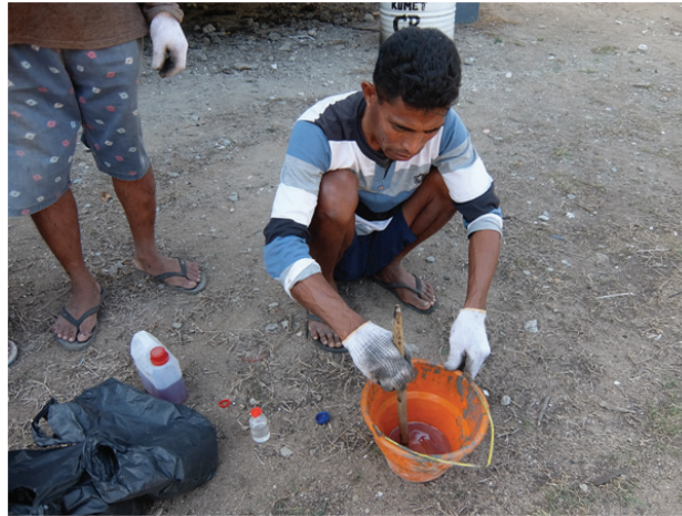
Gambar 12. Pembuatan larutan resin untuk melapisi rangka spider-web (Sumber: YAPEKA)
