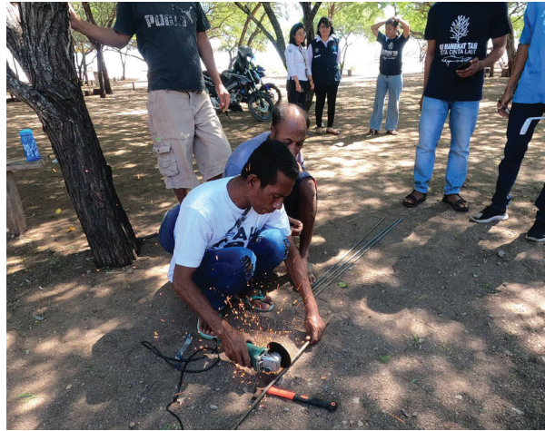
Gambar 8. Proses pemotongan besi menjadi beberapa ukuran berbeda (Sumber: YAPEKA)
