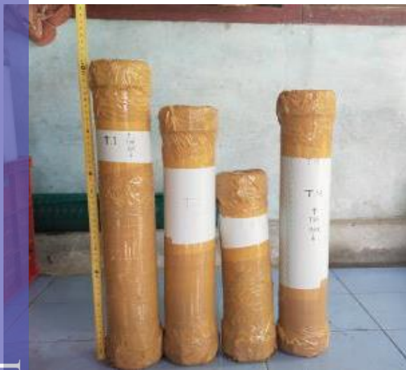
Proses penanganan sampel sedimen sebelum dikirim ke laboratorium
