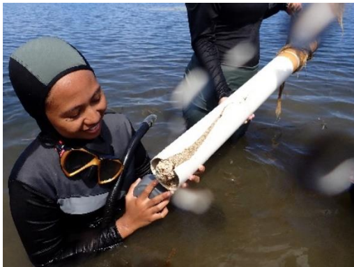
Pengambilan data sedimen menggunakan metode coring (2)
