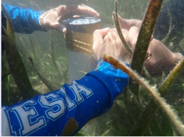
Pengambilan data sedimen menggunakan metode coring (1)
