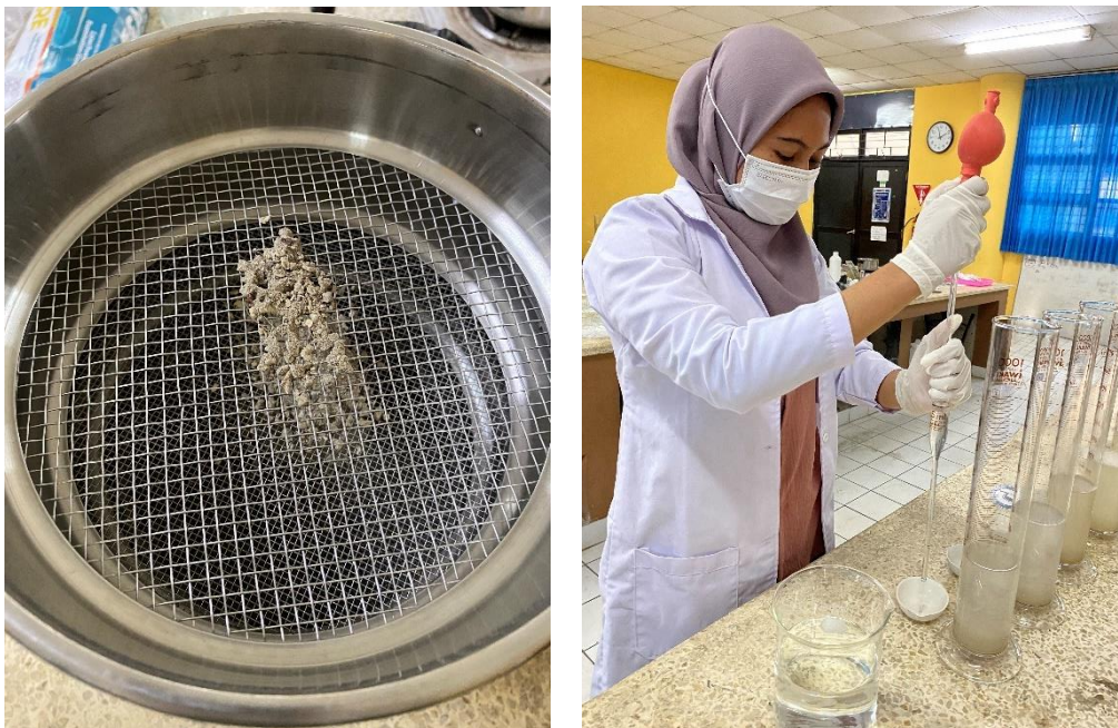
Proses analisis fraksi sedimen di laboratorium
